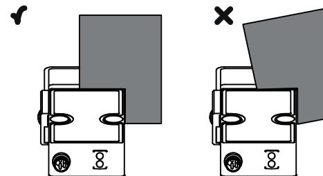
**AVIS! Les objets brillants et réfléchissants peuvent provoquer des interférences.** Inclinez les surfaces brillantes de >7° vers la face avant du détecteur.
