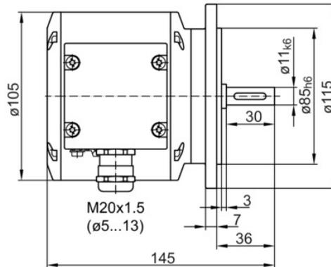
Mit EURO-Flansch B10 und 2x Klemmenkasten (Anschlusskennziffer -M)
