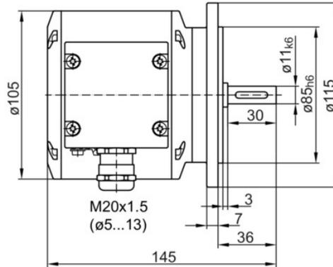
Mit EURO-Flansch B10 und 1x Klemmenkasten (Anschlusskennziffer -P)
