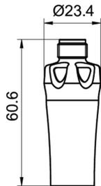
Gehäuse mit Dual Channel Messumformer und KingCrown Steckverbindung M12-A, 4-Pin (mit LED)
