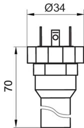
Gehäuse mit Messumformer und Steckverbindung DIN EN 175301-803 A (DIN 43650 A), 4-Pin
